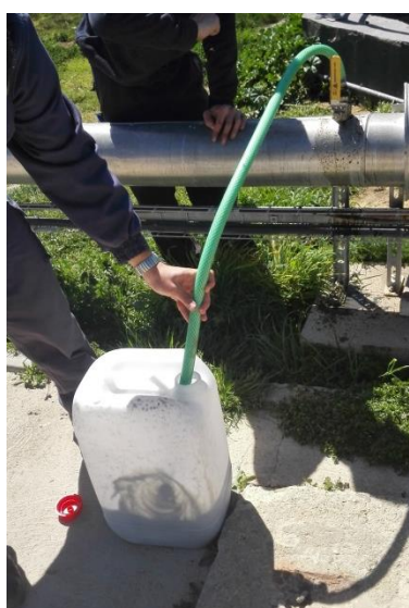
Figura 8. Toma de muestra de purines.
